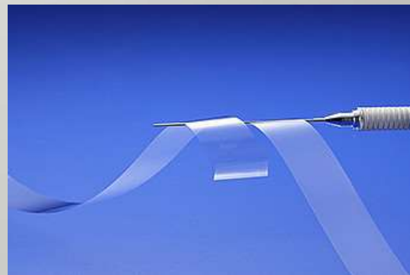
Willow üvegszalag, 100 \mu m vastag. PI hajlékony OLED kijelzők hordozója
